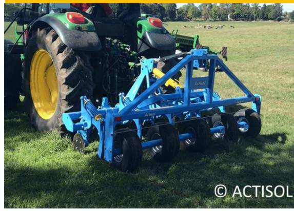
A l'automne 2024, une expérimentation sera mise en place afin de tester les impacts de la **fissuration sur la compaction des prairies, leur productivité et l'évolution de leur biodiversité**. La CUMA Terragr'Eau investit grâce au soutien de l'APIEME et du FEADER.
